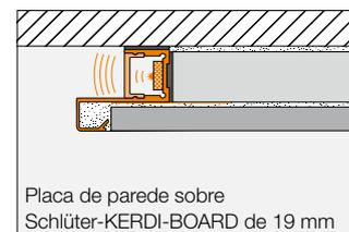
Placa de parede sobre Schlüter-KERDI-BOARD de 19 mm
